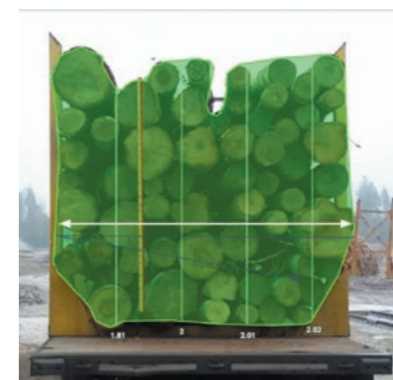
Рис. 2. Отметки высоты и ширины штабеля на транспортном средстве, определенные по автоматически найденной площади контура
