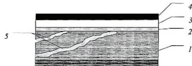
Рис. 5. Предлагаемая схема покрытия: 1 – древесина; 2 – слой изолирующего (барьерного) грунта; 3 – шпатлевка; 4 – финишное покрытие ЛКМ; 5 – смола (смоляные ходы)
