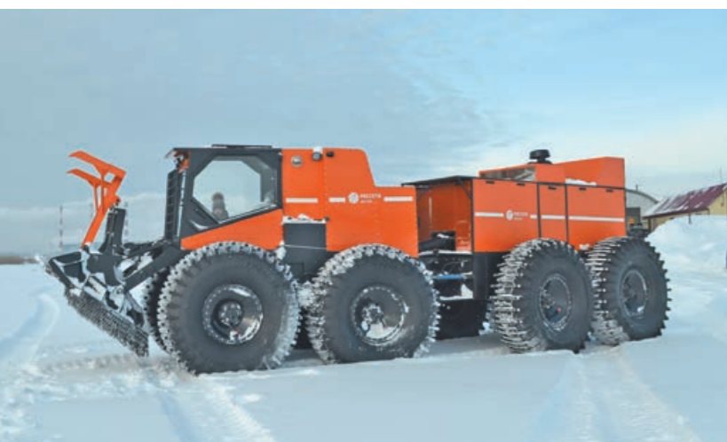
Рис. 2. Гидромеханический вездеход-мульчер «Тром-8 УЭС»
