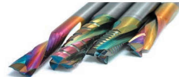
Рис. 2. Изменение цвета фрез при перегреве
