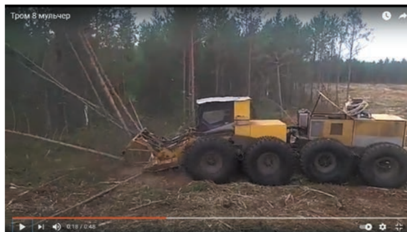
Рис. 3. Групповая обработка деревьев при помощи мульчера
