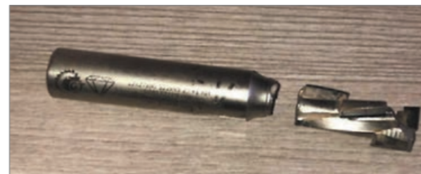
Рис. 1. Аварийный износ фрезы
