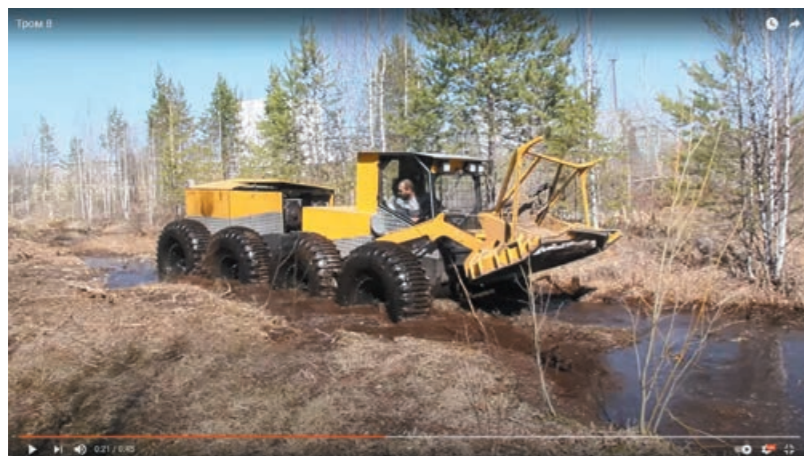
Рис. 6. Мульчирование ДКР в сложных почвенно-грунтовых условиях, на грунтах III и IV категорий
