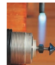
Рис. 5. Нагрев заклинившего цангового патрона ручного фрезера
