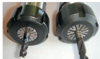
Рис. 2. Принцип зажима концевой фрезы при помощи конической цанги и гайки
