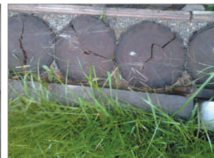
Дорожка из торцевых сосновых спилов через 1 год эксплуатации: слева – пропитанная препаратом группы ССА, справа – не пропитанная
