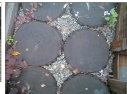
Дорожка из торцевых сосновых спилов через 1 год эксплуатации: слева – пропитанная препаратом группы ССА, справа – не пропитанная
