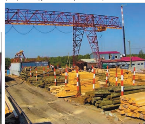
Изделия, пропитанные антисептиком «Элемсепт» (желто-рыжие – свежeproпитанные, оливковые – по завершении фиксации препарата, через неделю)
