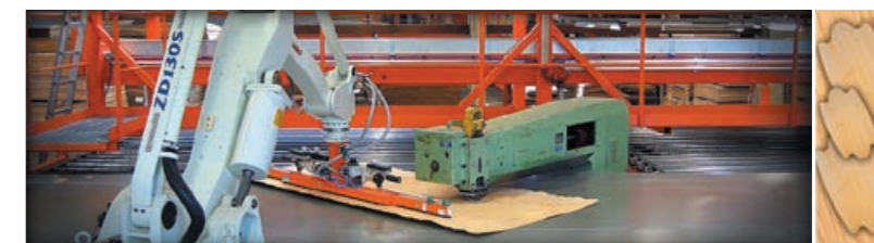
Рис. 4. Станок RoboPatching и форма заплаток для починки шпона, Plytec
