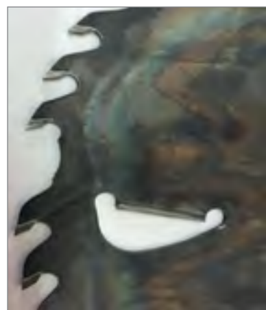
Рис. 6. Зуб пилы, вырванный «мясом»
