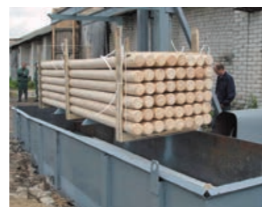
Рис. 6. Пропитка бревен в самодельной ванне
