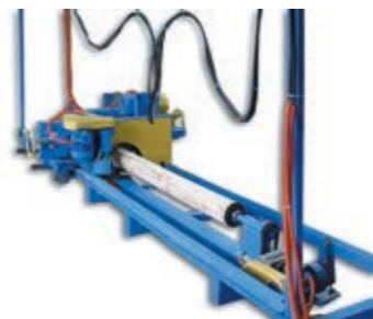
Рис. 2. Оцилиндровочный станок для тонкомера КБМ-200 (общий вид и схема обработки)
