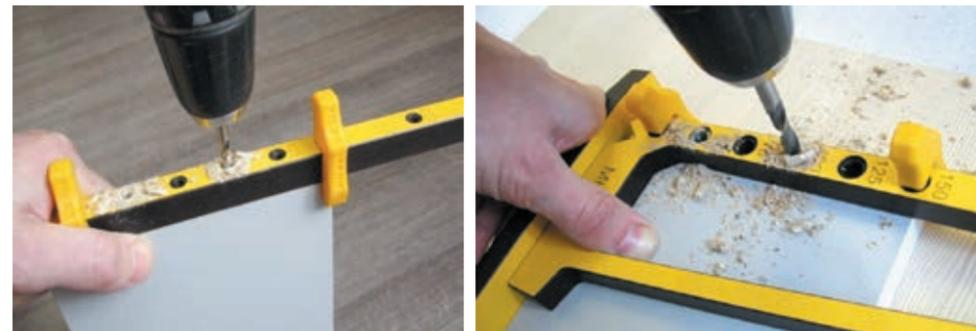
Рис. 2 Накладные кондукторы для сверления отверстий в торце и пласти плиты
