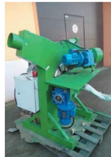
Рис. 4. Станок для окорки тонкомера («ТехноВудИнжиниринг»)
