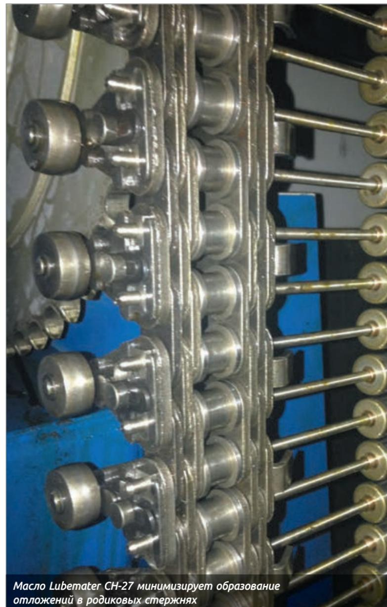
Масло Lubemater CH-27 минимизирует образование отложений в роликовых стержнях
