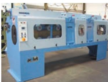
Рис. 1. Оцилиндровочный станок RHM с двумя фрезерными головками от Wema Probst
