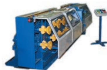
Рис. 3. Оцилиндровочный станок СК-14 (ООО «СТИН»)
