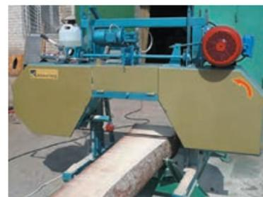
Рис. 16. Ленточно-пильный станок для бревен ЛП-60
