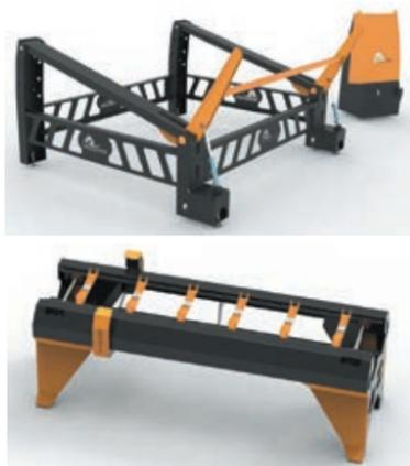
Рис. 14. Бревнотаска и гидропогрузчик с накопителем к станку УГП-2
