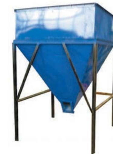
Рис. 13. Бункер-накопитель БН-10 («Станколестрейд»): объем емкости 10 м<sup>3</sup>, диаметр емкости 2200 мм, высота емкости 3700 мм, вес 600 кг, высота выгрузки 1000 мм, диаметр выгрузного отверстия 280 мм
