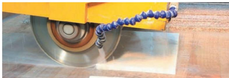
Рис. 3. Обдув круглой пилы сжатым воздухом
