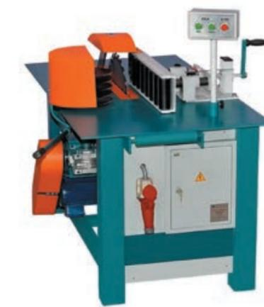
Рис. 4. Горбыльный станок ГР-500
