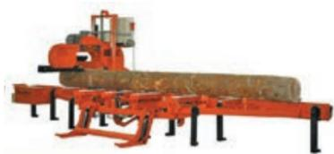
Рис. 17. Ленточно-пильный станок для бревен WoodMizer LT40M
