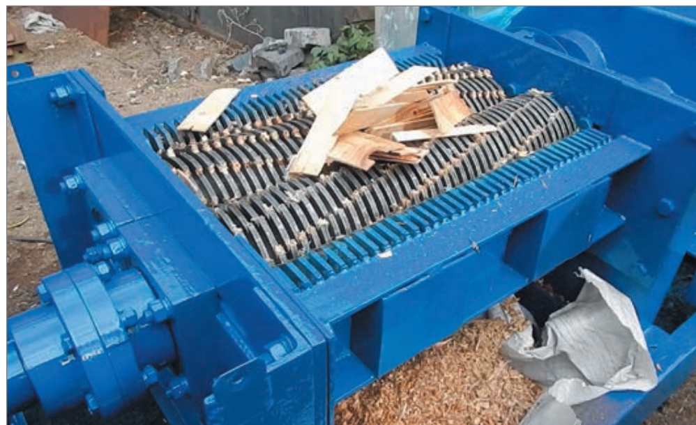
Рис. 15. Дробилка на основе сборных валов с насадными фрезами
