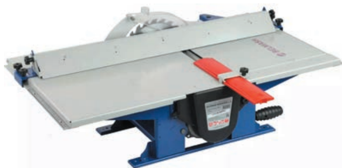
Рис. 1. Станок «Белмаш» Могилев 2.4 СДМЛ-2400
