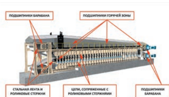
Основные точки смазки линии непрерывного производства древесно-композитных плит
