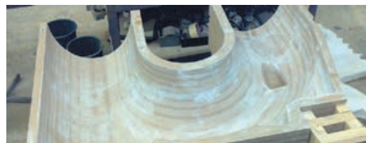
Рис. 5. Модель из переклеенных MDF
