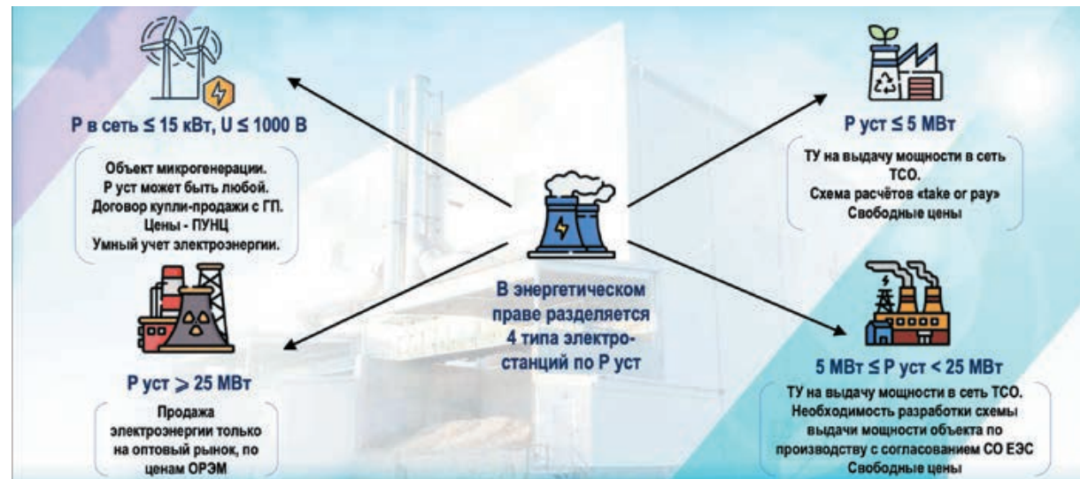
Рис. 2. Классификация электростанций по мощности, условиям присоединения и продажи электроэнергии
