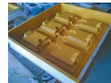
Рис. 3. Литейная модель из березовой фанеры
