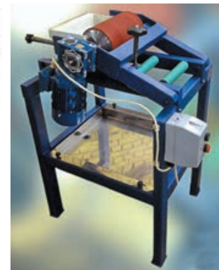
Рис. 7. Клеяноносящий станок УНК-01, «Лоза»
