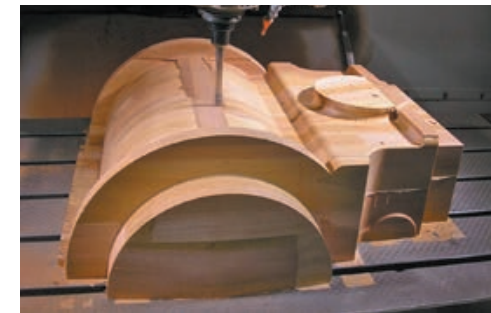
Рис. 2. Фрезерование модели из переклеенной древесины
