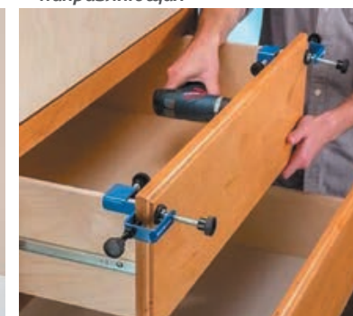
Рис. 9. Крепление ящичного фасада
