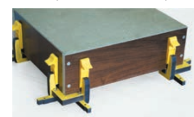
Рис. 10. Кондукторы для крепления задней стенки мебели при сборке
