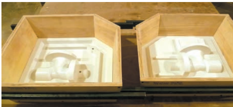
Рис. 4. Разъемная оснастка из фанеры, покрытая пластиком
