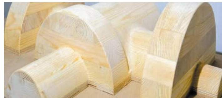
Рис. 1. Модель для литья, изготовленная из хвойной древесины
