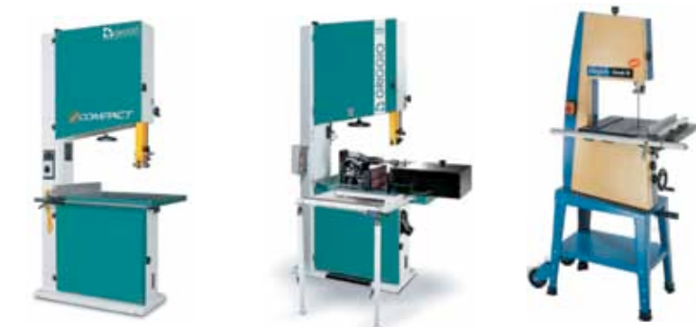
Столярные ленточнопильные станки (слева направо): с ручной подачей материала; с автоподатчиком; с наклонным столом.
