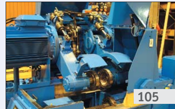
Обрезной станок с дополнительными шпинделями для раскря толстых досок на заготовке
