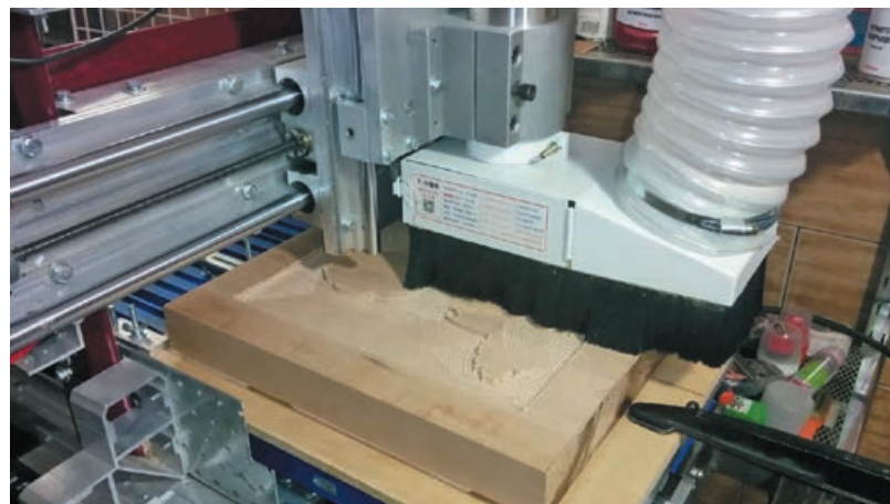
Рис. 6. Пылесос из стали с нижним щеточным заполнением на станке с ЧПУ
